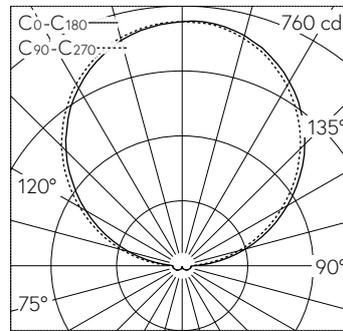
LED 4000 K 25 W 2317 lm-h 116° / CIE Flux 15 38 67 6 100 / E13 selon DIN 5040
