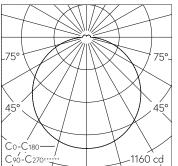
LED 3000 K 47.4 W 3176 lm-h 116° / CIE Flux 45 75 93 94 100 / A41 selon DIN 5040
