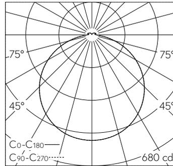
LED 3000 K 22 W 1805 lm-h 116° / CIE Flux 45 77 94 95 100 / A41 selon DIN 5040
