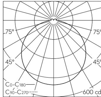
LED 4000 K 22 W 1830 lm-h 116° / CIE Flux 45 76 94 93 100 / A41 selon DIN 5040
