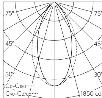
LED 3000 K 16.5 W 1729 lm-h / CIE Flux 84 98 100 100 100 / A70 selon DIN 5040
