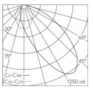
LED 4000 K 16.5 W 1426 lm-h / CIE Flux 48 84 98 100 100 / A40 selon DIN 5040
