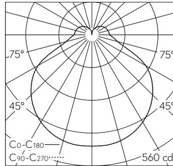
LED 3000 K 21 W 1970 lm-h / CIE Flux 42 74 91 82 100 / B31 selon DIN 5040
