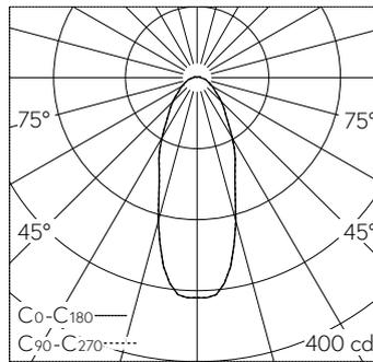
LED 3000 K 5.6 W 309 lm-h / CIE Flux 67 86 95 95 100 / A61 selon DIN 5040
