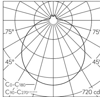
LED 2700 K 32 W 3201 lm-h / CIE Flux 42 71 89 87 100 / B31 selon DIN 5040
