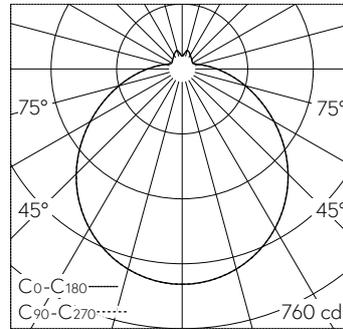
LED 3000 K 32 W 3201 lm-h / CIE Flux 42 71 89 87 100 / B31 selon DIN 5040
