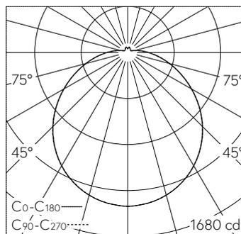
LED 3000 K 49 W 5801 lm-h / CIE Flux 43 72 90 92 100 / A31 selon DIN 5040
