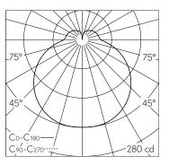
LED 3000 K 15.5 W 1001 lm-h / CIE Flux 38 68 88 79 100 / B31 selon DIN 5040
