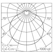
LED 2700 K 31 W 3472 lm-h / CIE Flux 40 70 89 84 100 / B31 selon DIN 5040
