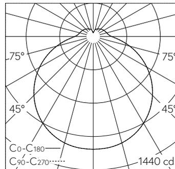
LED 3000 K 48 W 5072 lm-h / CIE Flux 40 70 89 84 100 / B31 selon DIN 5040
