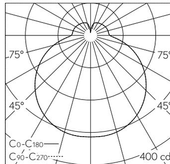
LED 3000 K 19,6 W 1473 lm-h / CIE Flux 39 68 88 78 100 / B32 selon DIN 5040
