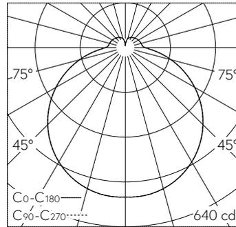
LED 3000 K 19.6 W 2145 lm-h / CIE Flux 41 71 90 85 100 / B32 selon DIN 5040
