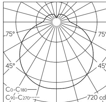
LED 3000 K 31 W 2822 lm-h / CIE Flux 39 68 88 79 100 / B32 selon DIN 5040
