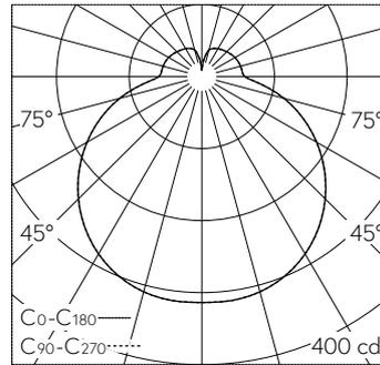
LED 3000 K 21.5 W 1473 lm-h / CIE Flux 39 68 88 78 100 / B32 selon DIN 5040
