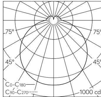
LED 3000 K 32.2 W 3384 lm-h / CIE Flux 41 71 90 85 100 / B32 selon DIN 5040
