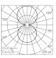
LED 3000 K 19.3 W 1174 lm-h / CIE Flux 40 71 90 48 100 / C33 selon DIN 5040
