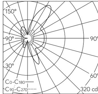
LED 3000 K 7.4 W 538 lm-h / CIE Flux 31 55 77 44 100 / C22 selon DIN 5040
