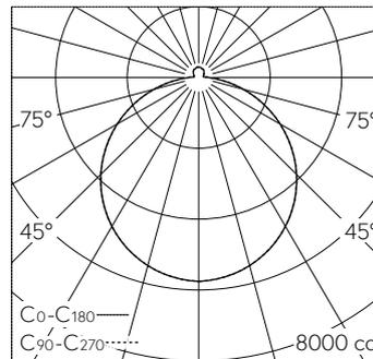
LED 4000 K 134 W 18314 lm-h / CIE Flux 45 76 93 94 100 / A42 selon DIN 5040
