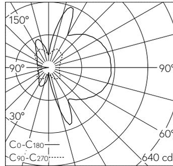
LED 3000 K 20 W 1618 lm-h / CIE Flux 25 49 74 47 100 / C12 selon DIN 5040
