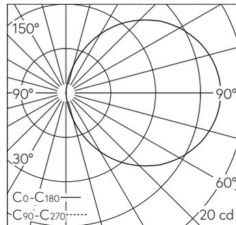
LED 3000 K 2.1 W 49 lm-h / CIE Flux 13 37 66 50 100 / C11 selon DIN 5040
