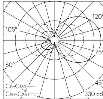
LED 4000 K 22.6 W 1976 lm-h / CIE Flux 16 41 69 49 100 / C11 selon DIN 5040
