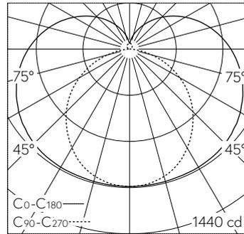
LED 3000 K 62 W 6511 lm-h / CIE Flux 33 60 82 73 100 / B21 selon DIN 5040
