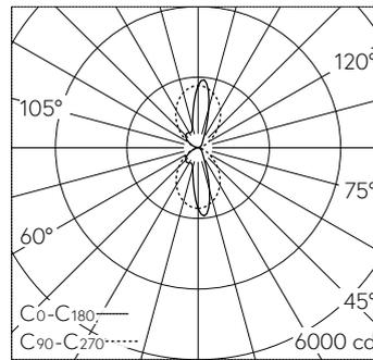
LED 4000 K 37 W 3990 lm-h / CIE Flux 62 88 98 50 100 / C54 selon DIN 5040
