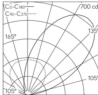
LED 4000 K 12.5 W 1121 lm-h / CIE Flux 0 0 0 100 / E83 selon DIN 5040
