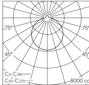
LED 0 K 114 W 13010 lm-h / CIE Flux 44 75 92 90 100 / A42 selon DIN 5040
