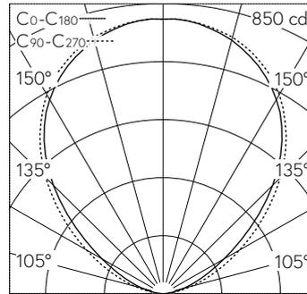
LED 4000 K 19.1 W 1907 lm-h / CIE Flux 0 0 0 100 / E83 selon DIN 5040
