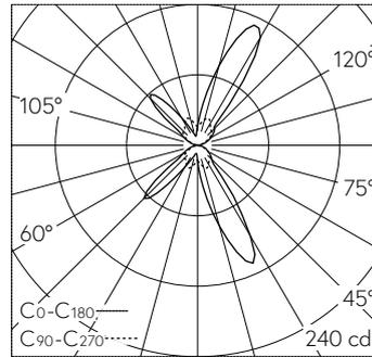
LED 3000 K 10 W 249 lm-h / CIE Flux 58 88 98 48 100 / C54 selon DIN 5040
