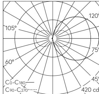
LED 2700 K 16.1 W 1444 lm-h / CIE Flux 14 38 67 50 100 / C11 selon DIN 5040
