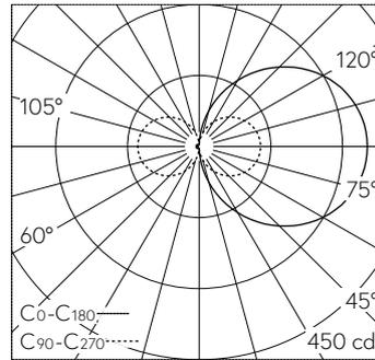
LED 3000 K 16.1 W 1491 lm-h / CIE Flux 14 38 67 50 100 / C11 selon DIN 5040
