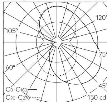
LED 3000 K 10 W 749 lm-h / CIE Flux 32 59 81 50 100 / C22 selon DIN 5040
