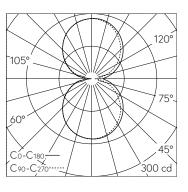
LED 3000 K 20 W 1189 lm-h / CIE Flux 43 72 91 50 100 / C33 selon DIN 5040
