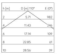
LED 3000 K 100 W 10770 lm-h 110° / CIE Flux 49 80 96 100 100 / A40 selon DIN 5040
