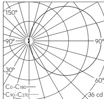
LED 3000 K 3 W 100 lm-h / CIE Flux 14 39 67 50 100 / C11 selon DIN 5040
