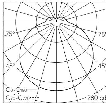
LED 2700 K 9.5 W 1071 lm-h / CIE Flux 39 68 88 82 100 / B31 selon DIN 5040
