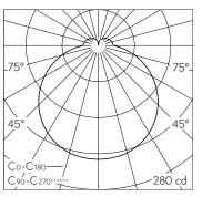
LED 2700 K 10.5 W 942 lm-h / CIE Flux 40 69 89 83 100 / B31 selon DIN 5040
