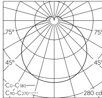
LED 3000 K 10.5 W 957 lm-h / CIE Flux 40 69 89 83 100 / B31 selon DIN 5040
