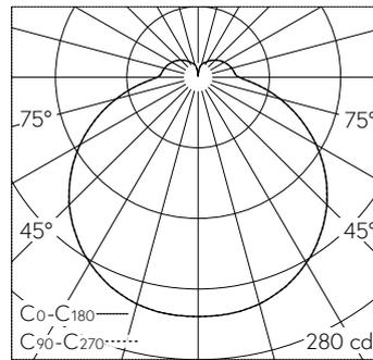
LED 2700 K 10.5 W 1071 lm-h / CIE Flux 39 68 88 82 100 / B31 selon DIN 5040
