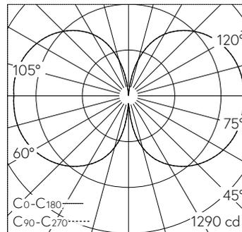
LED 4000 K 104.8 W 11566 lm-h / CIE Flux 18 44 71 51 100 / C11 selon DIN 5040
