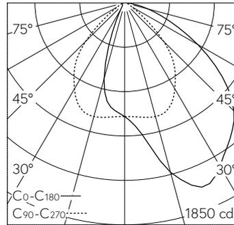
LED 3000 K 19.5 W 2129 lm-h / CIE Flux 60 89 98 100 100 / A50 selon DIN 5040
