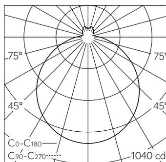
LED 3000 K 31 W 3088 lm-h / CIE Flux 44 74 91 87 100 / B32 selon DIN 5040
