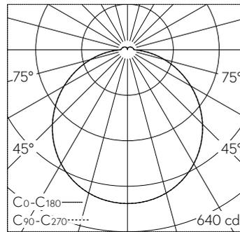
LED 3000 K 20.5 W 1762 lm-h / CIE Flux 44 75 93 94 100 / A41 selon DIN 5040
