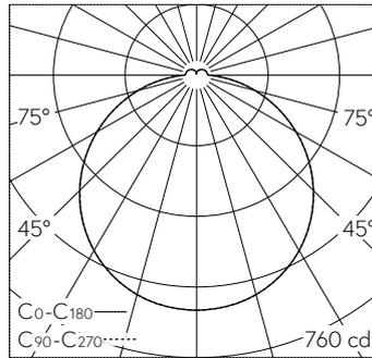
LED 3000 K 31.5 W 2444 lm-h / CIE Flux 44 75 92 93 100 / A41 selon DIN 5040
