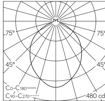
LED 2700 K 9.7 W 943 lm-h / CIE Flux 55 87 92 100 / A52 selon DIN 5040
