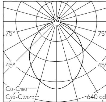
LED 2700 K 13.5 W 1333 lm-h / CIE Flux 54 85 97 90 100 / A53 selon DIN 5040
