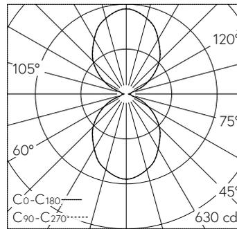
LED 3000 K 19 W 1774 lm-h / CIE Flux 55 86 97 50 100 / C54 selon DIN 5040
