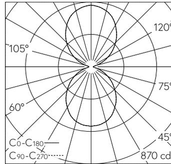
LED 3000 K 26.3 W 2557 lm-h / CIE Flux 54 84 97 49 100 / C53 selon DIN 5040
